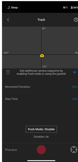
Die Wegpunktfunktion ist dafür ausgelegt, Videos mit bis zu 10 Wegpunkten aufzunehmen. Man muss den Wegpunkt manuell auswählen, indem man den Gimbal bewegt oder den virtuellen Steuerknüppel verwendet. Der Dauer-Parameter unter der Gitterkarte gibt an, wie viel Zeit der Gimbal benötigt, um von einem Wegpunkt zum nächsten zu gelangen. Die Verweildauer bestimmt, wie lange der Gimbal an einem Wegpunkt ruht, bevor er zum nächsten Wegpunkt wechselt.
