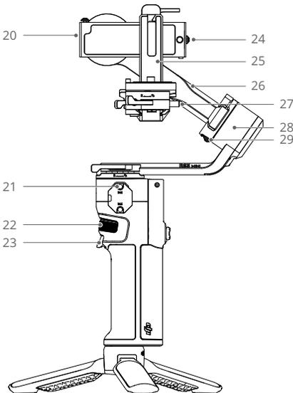
20. RSS-Kamerasteuerungsanschluss (USB-C)
