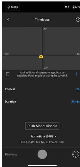
Im Zeitraffer-Modus löst der DJI RS 3 Mini die Kamera aus, um Standbilder mit der gewünschten Intervallzeit aufzunehmen, und stoppt nach dem Abschluss automatisch. Die Dauer des Zeitraffers und die Bildrate können so eingestellt werden, dass der DJI RS 3 Mini die genaue Anzahl der benötigten Bilder berechnen kann.
